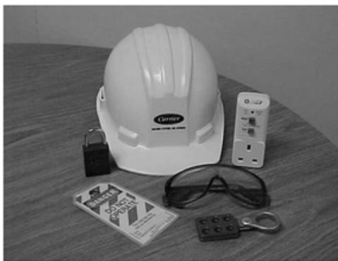
После завершения работ по диагностике и техническому обслуживанию необходимо завершить процедуру блокировки и установки предупреждающих табличек.
